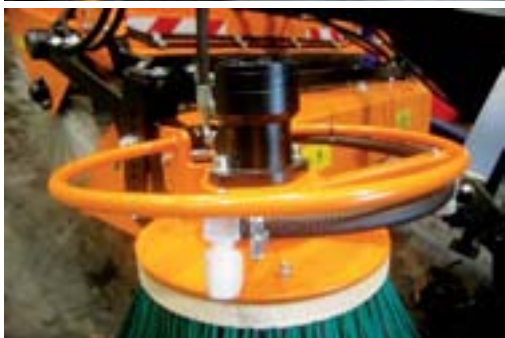
Фотография: Защитная конструкция боковой щетки
