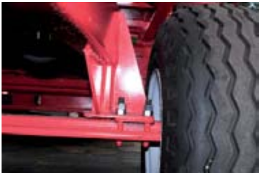
Фотография: Ось прицепа с амортизацией при помощи шин
