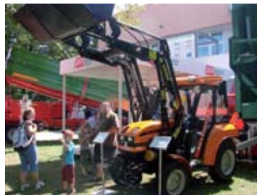
Фотография: Коммунальный трактор PRONAR 320AMK с фронтальным погрузчиком LC2 и ковшом для сыпучих материалов
