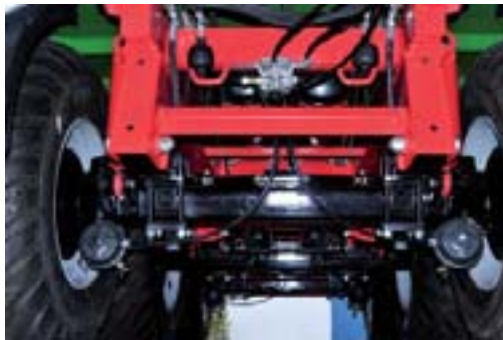
Фотография: Прицеп PRO-NAR T900 с шасси тридем, самоуправляемые мосты
