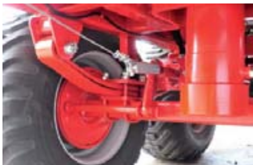
Фотография: Металлические ограничители и параболические рессоры, прикрепленные к оси квадратного сечения
