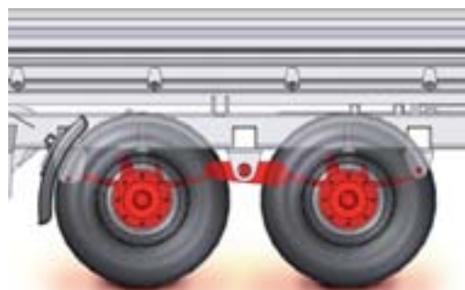
Фотография: Низкая подвеска в прицепе Т 663/4
