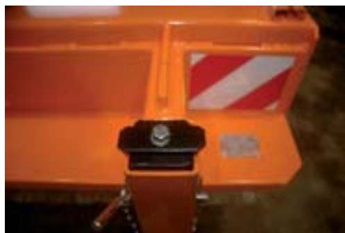
Фотография: Защита опорного колеса от случайного выпадения
