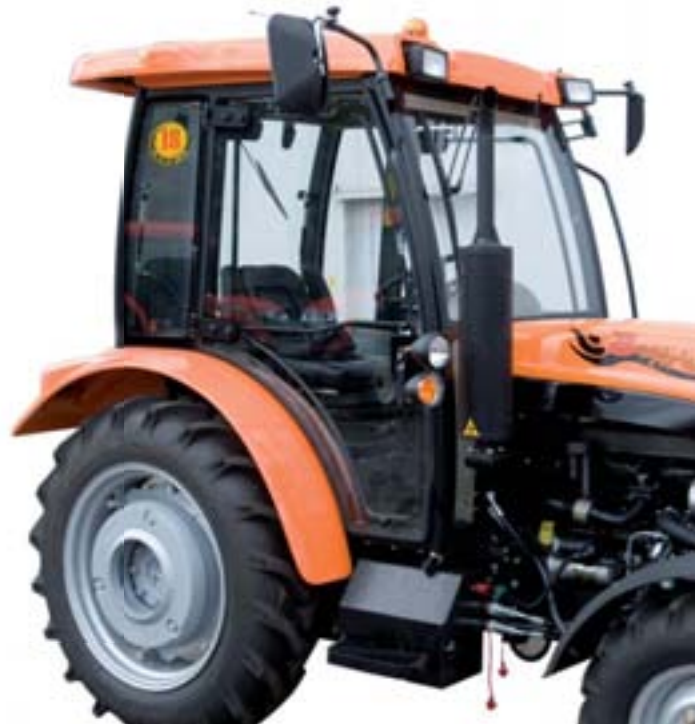
Фотография: Готовая и смонтированная кабина трактора Zefir 40
