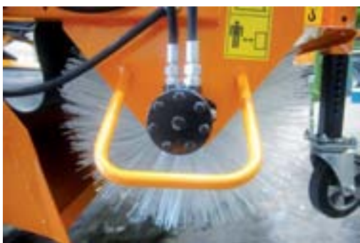
Фотография: Защитная конструкция гидравлического двигателя
