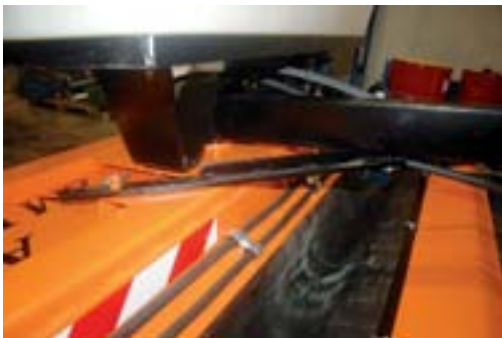
Фотография: Планка, регулирующая угол работы подметально-уборочной машины
