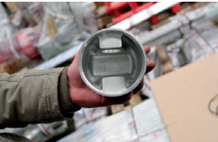
Фотография: оригинальные запасные части можно узнать по выбитым на них торговым знакам производителя
