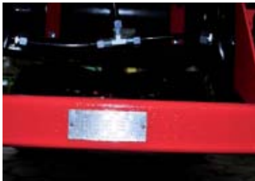
Фотография: Типовая табличка с наиболее важными техническими данными оси прицепа
